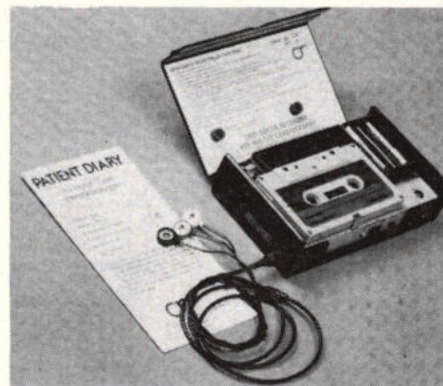
Afb. 1. Een speciale cassetterecorder en een dagboekje voor de patiënt verschaffen de data: het ECG over 24 uur, met notities.
