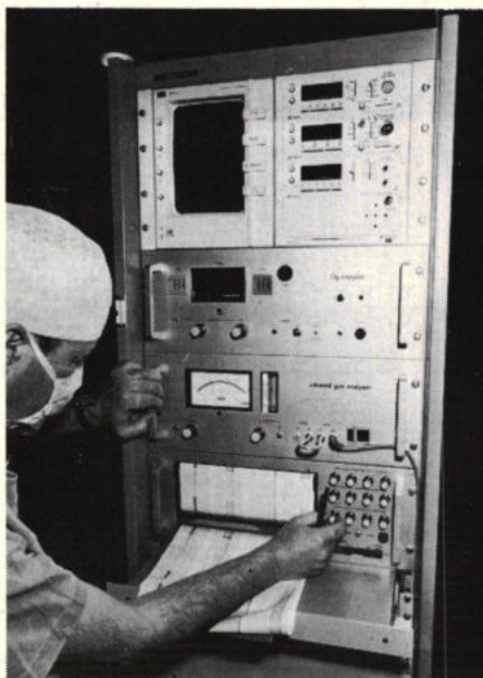
Afb. 3 Apparatuur voor monitoring tijdens operaties ontwikkeld in het Instituut voor Anaesthesiologie van de Rijksuniversiteit Utrecht.
